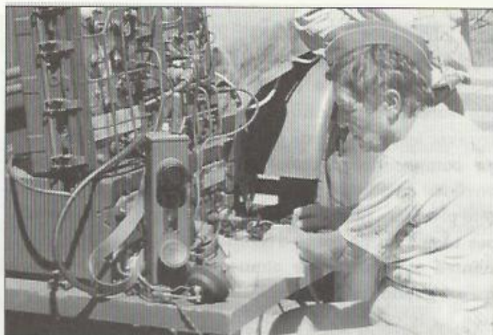
F6DXB opérant la station ANGRCS - Ampli (100 watts). Au premier plan, un talkie walkie SCR536 fonctionnant en MA dans la bande des 80 mètres.
